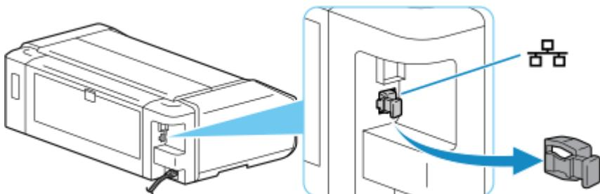
4. 使用乙太網路電纜線連接印表機和網路裝置(路由器等)。
