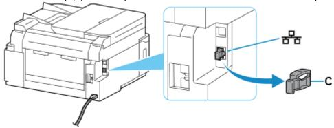
5. 使用乙太網路電纜線(D)連接印表機和網路裝置(路由器等)。 請勿連接到任何其他連接埠。
