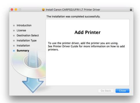
9. 完成安裝驅動程式後需新增印表機,請使用 USB 線連接印表機與電腦並啟動印表機,再按一下電腦左上角< ● >圖 案,選擇<系統偏好設定>,再選擇<印表機和掃描器>
