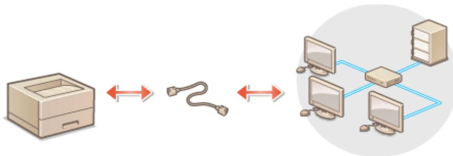
12. 使用區域網路纜線將本機連接到路由器，推入接頭，直至聽到喀嗒聲，開啟印表機
