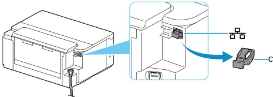
5. 使用乙太網路電纜線(D)連接印表機和網路裝置(路由器等)。
