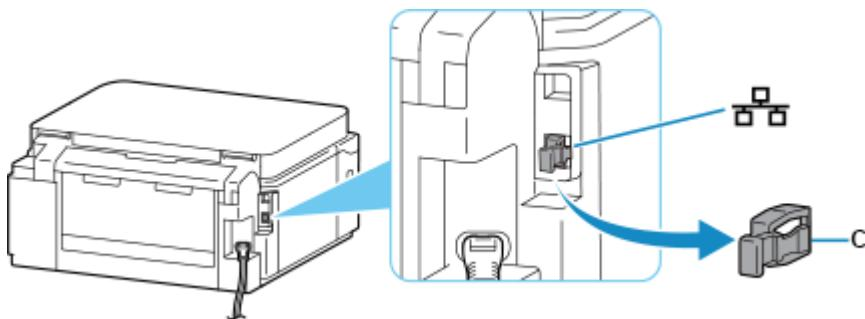
5. 使用乙太網路電纜線(D)連接印表機和網路裝置(路由器等)。
