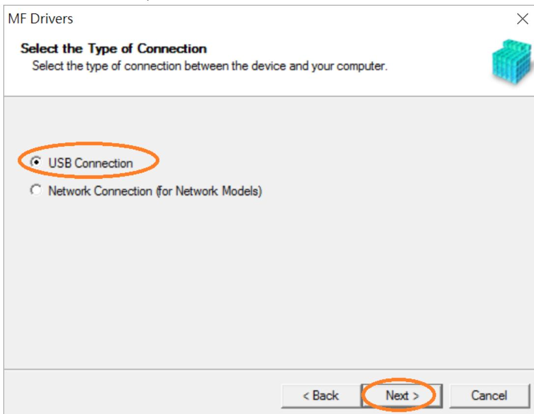
6. 以 USB 線接駁打印機及電腦，然後開啟打印機
