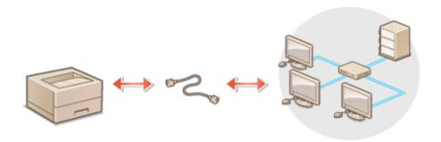
10. 使用區域網路纜線將本機連接到路由器,推入接頭,直至聽到喀嗒聲,開啟印表機
