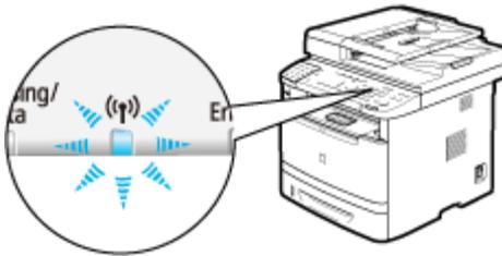
25. 以下圖示為設定完成。其後約2秒後，操作面板的Wi-Fi顯示燈將亮起，請再等待約2分鐘（IP位址及其他設定將會自動完成）
