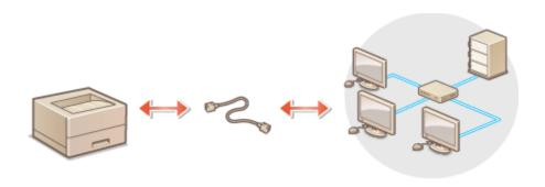
11. 使用區域網路纜線將本機連接到路由器,推入接頭,直至聽到喀嗒聲,開啟印表機
