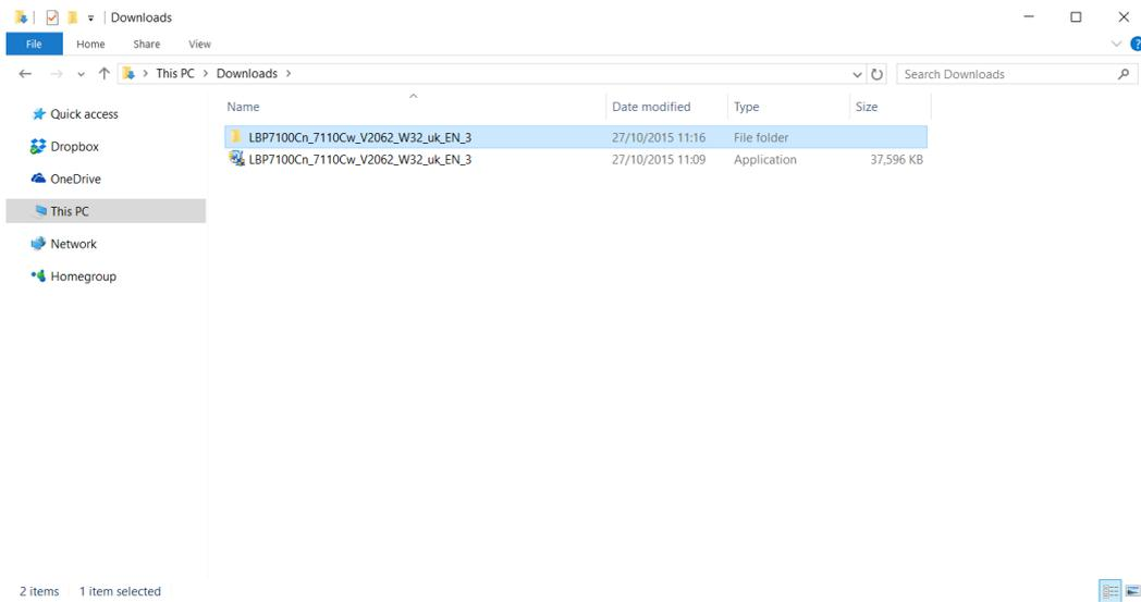
14. 進入文件夾，「Driver」文件夾，然後開啓“Setup.exe”文件開始安裝設定 (Go into “Driver”, then Double Click / Open “Setup.exe”)
