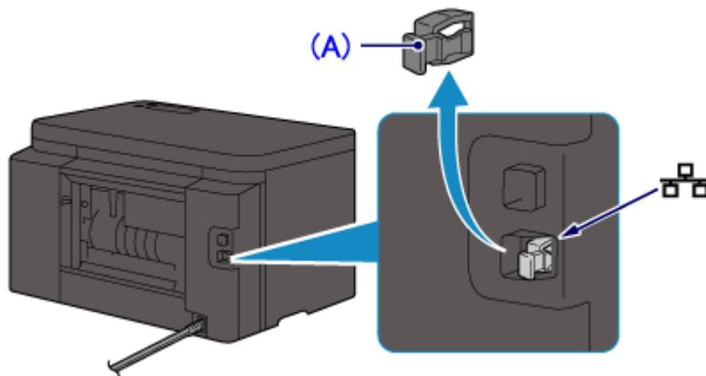
3. 使用乙太網路纜線 (B) 連接印表機和網路設備 (路由器等)。
