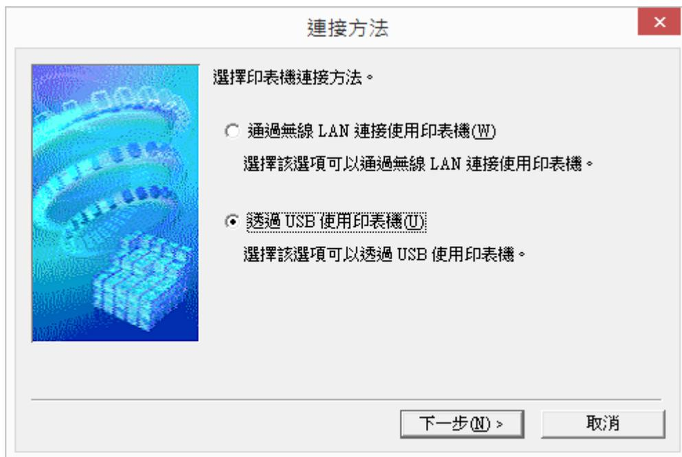
7. 開啟印表機，將 USB 連接電腦及打印機，並等待電腦偵測及安裝
