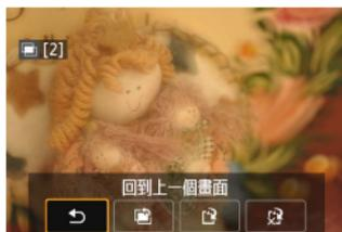
完成拍攝設定的曝光數前，可按下<▶>按鈕檢視目前為止合併後的多重曝光影像。可查看拍攝效果及曝光。
