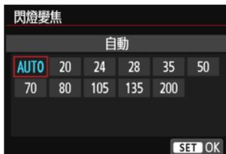
使用具有變焦閃光燈頭的閃光燈時，可設定閃光燈覆蓋範圍。一般情況下，請將此功能設為[AUTO]，以便相機自動設定適合鏡頭焦距的閃光燈覆蓋範圍。
