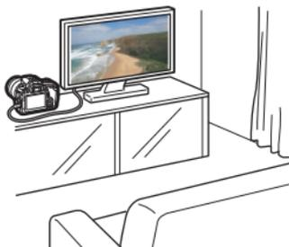
使用另行購買的HDMI連接線HTC-100或另行購買的立體聲影音連接線AVC-DC400ST連接相機至電視機。然後您便可在電視機上播放拍攝的短片及靜止影像。如您擁有高清電視機並使用HDMI連接線連接相機，您便可以更高的影像畫質觀看全高清(Full HD：1920×1080)及高清(HD：1280×720)短片。
