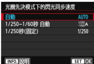
在光圈先決自動曝光(**Av**)模式下可設定閃燈攝影的閃燈同步速度。
